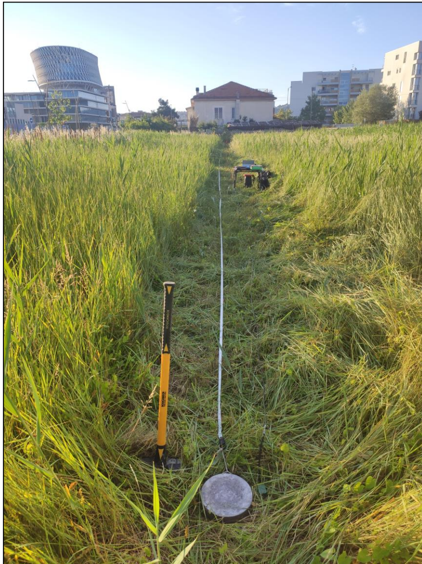
Foto stendimento sismico
